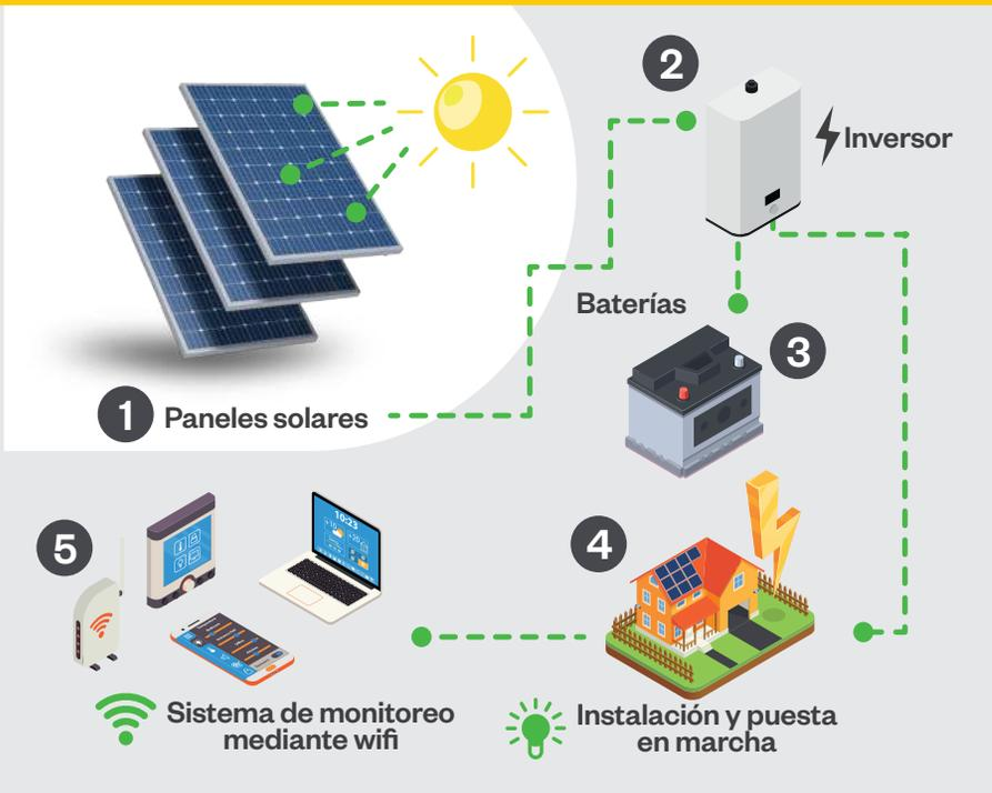
**Sistema no conectado a la red con baterías:** este tipo de sistema puede ser usado en sitios remotos en donde llevar una línea de transmisión resulta muy costoso. El sistema fotovoltaico provee de energía y se convierte en una fuente de carga para las baterías durante las horas de sol. En los momentos que no hay generación fotovoltaica la energía es provista por el banco de baterías.
