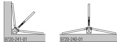
Si los trípodes plegables no se pueden abrir completamente en los extremos de los edificios, aperturas de los forjados, etc., recomendamos sujetar el trípode plegable a otro puntal en el que sea posible abrir el trípode completamente.
