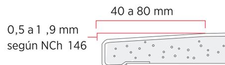
Borde Rebajado, rebaje de borde longitudinal de la placa para terminación con Masilla Base Romeral
