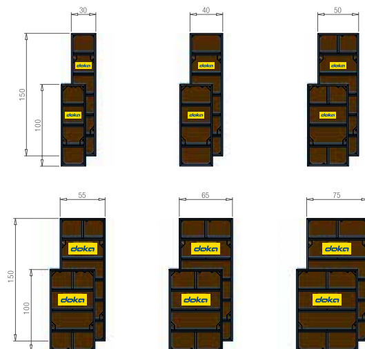
Retícula lógica del sistema de 5 cm para una adaptabilidad perfecta
