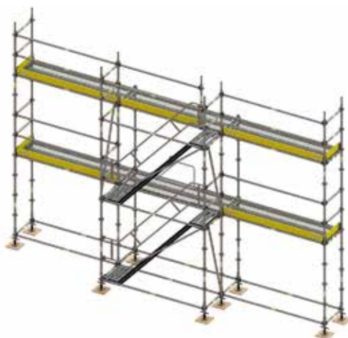
DokaScaff como andamio de trabajo con la escalera de acceso integrada.
