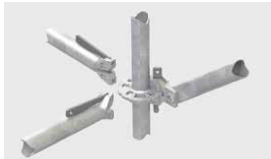
Discos modulares con ocho posibilidades de conexión lo que permite adaptación rápida y flexible a diferentes alturas, anchos y longitudes.
